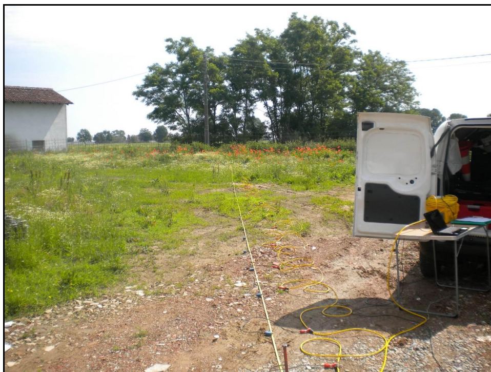
Vista dello stendimento MASW 5 – Area A5
