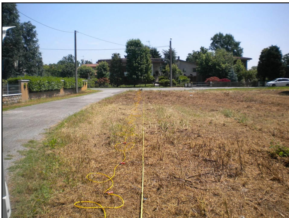
Vista dello stendimento MASW 3 – Area A3
